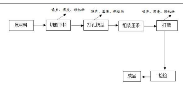
图 2-3 金属门窗生产工艺流程图
