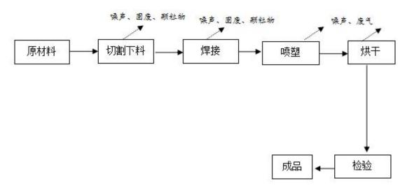
图 2-4 金属护栏生产工艺流程图
